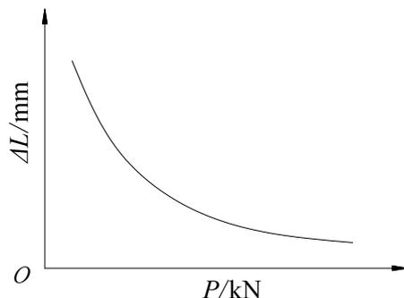
支架工作阻力与顶板下沉量的关系在一定程度上反映了支架与围岩的相互作用关系。工作阻力  $P$  与顶板最终下沉量是一近似的双曲线，或称“ $P-\Delta L$ ”曲线。由这条曲线可知：在一定工作阻力以上，支架工作阻力增加对顶板下沉量影响较小，但低于此值时则影响极大，采场支架的工作阻力并不能改变上覆岩层的总体活动规律，事实上，只能在工作阻力偏低的情况下，提高工作阻力才有可能对顶板下沉有显著影响。
